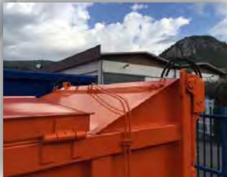
*Porta idraulica basculante con coda rialzata e lamiera per impedire sversamento liquidi*
